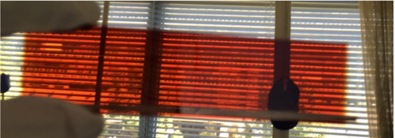
Рис. 7. Вигляд звичайного вікна крізь зразок STPV-комірки
