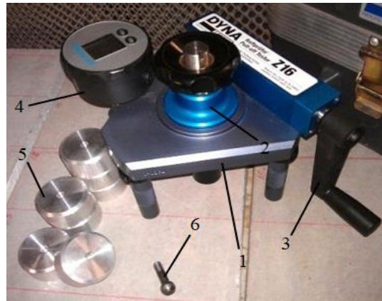
Рис. 2. Адгезиметр DYNA Z16: 1 – канвас; 2 – фіксатор; 3 – подача навантаження; 4 – манометр; 5 – випробувальний диск відривач \varnothing 50 мм; 6 – M8
