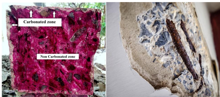
Рис. 1. Карбонізована та не карбонізовані зони бетону і руйнування елемента
