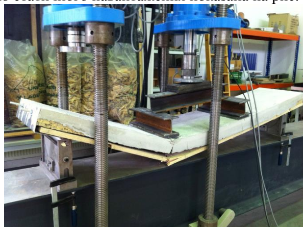
Рис. 5. Випробування деревобетонної панелі на міцність до руйнування
