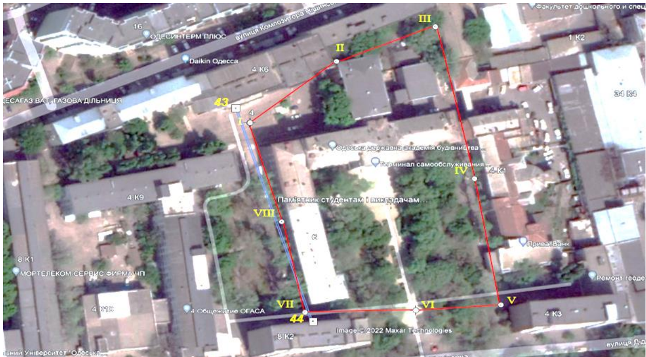
Рисунок 1. Один із типових варіантів теодолітного ходу
