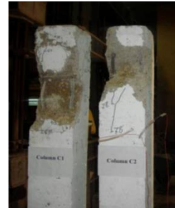
Рис. 4. Характерні пошкодження колон, навантажених осьовою силою (Rabi M.)
