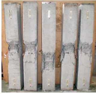
Рис. 3. Характерні пошкодження колон, навантажених осьовою силою (J. Němeček)
