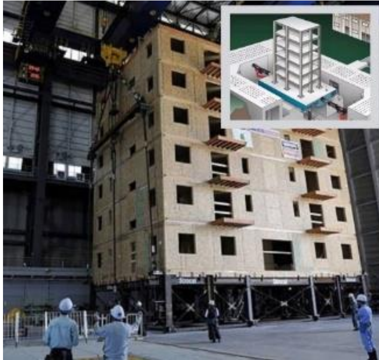
Рис. 1. Дослідження на сейсмостійкість дерев'яних конструкцій в Японії
