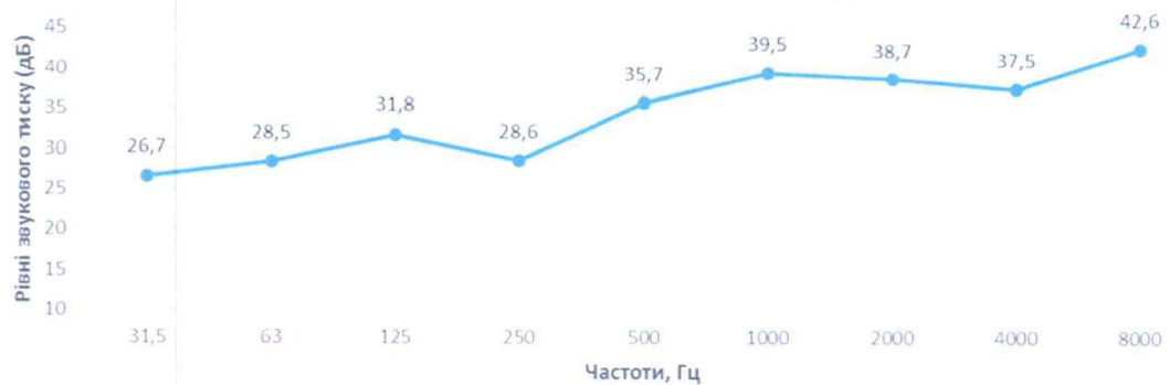
Індекс ізоляції повітряного шуму конструкції в октавних смугах з середньгеометричними частотами дБА
