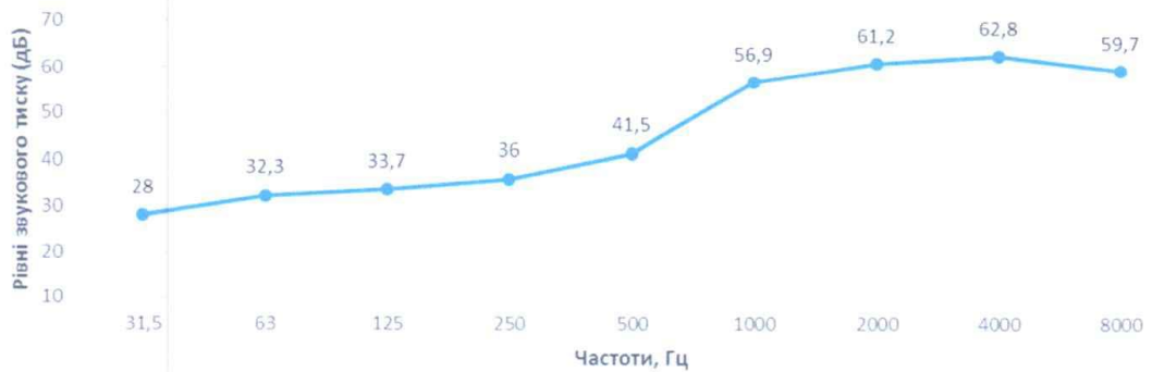
Індекс ізоляції повітряного шуму конструкції в октавних смугах з середньгеометричними частотами дБА
