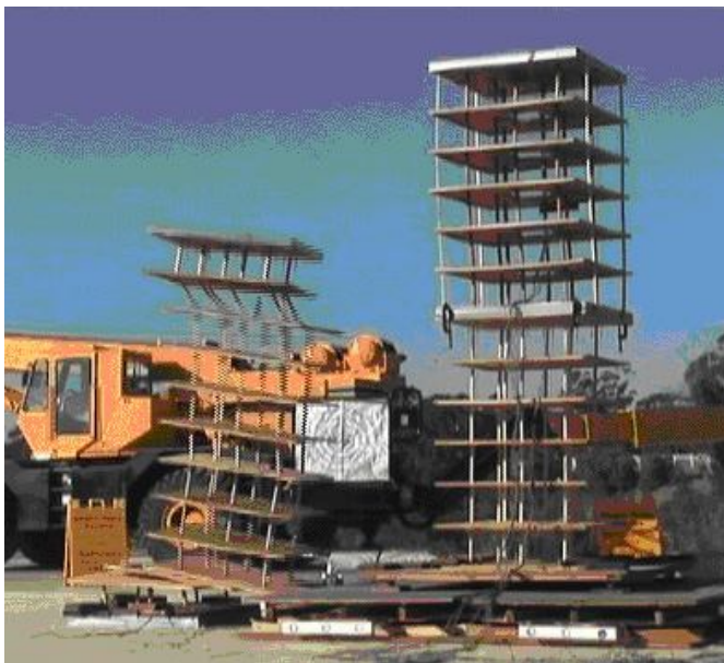
Рис.2. Пример испытания на сейсмоплатформе до разрушения.
