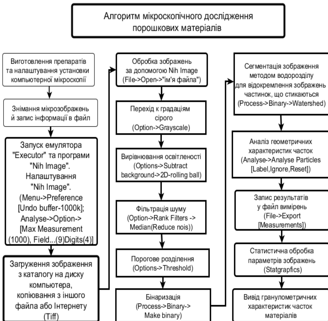
Рис. 3.20. Алгоритм дослідження порошкоподібних матеріалів методом комп'ютерної мікроскопії
