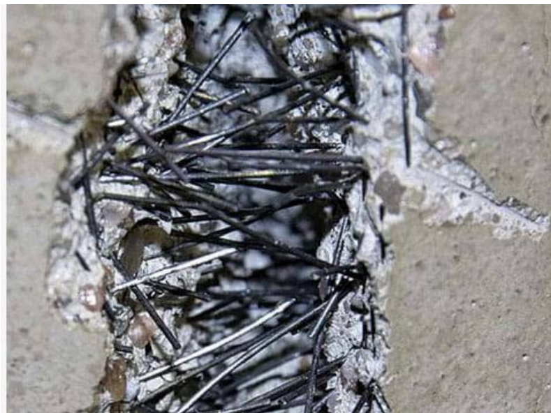
Рис.4.6. Зображення бетону, що армований сталевую фіброю
