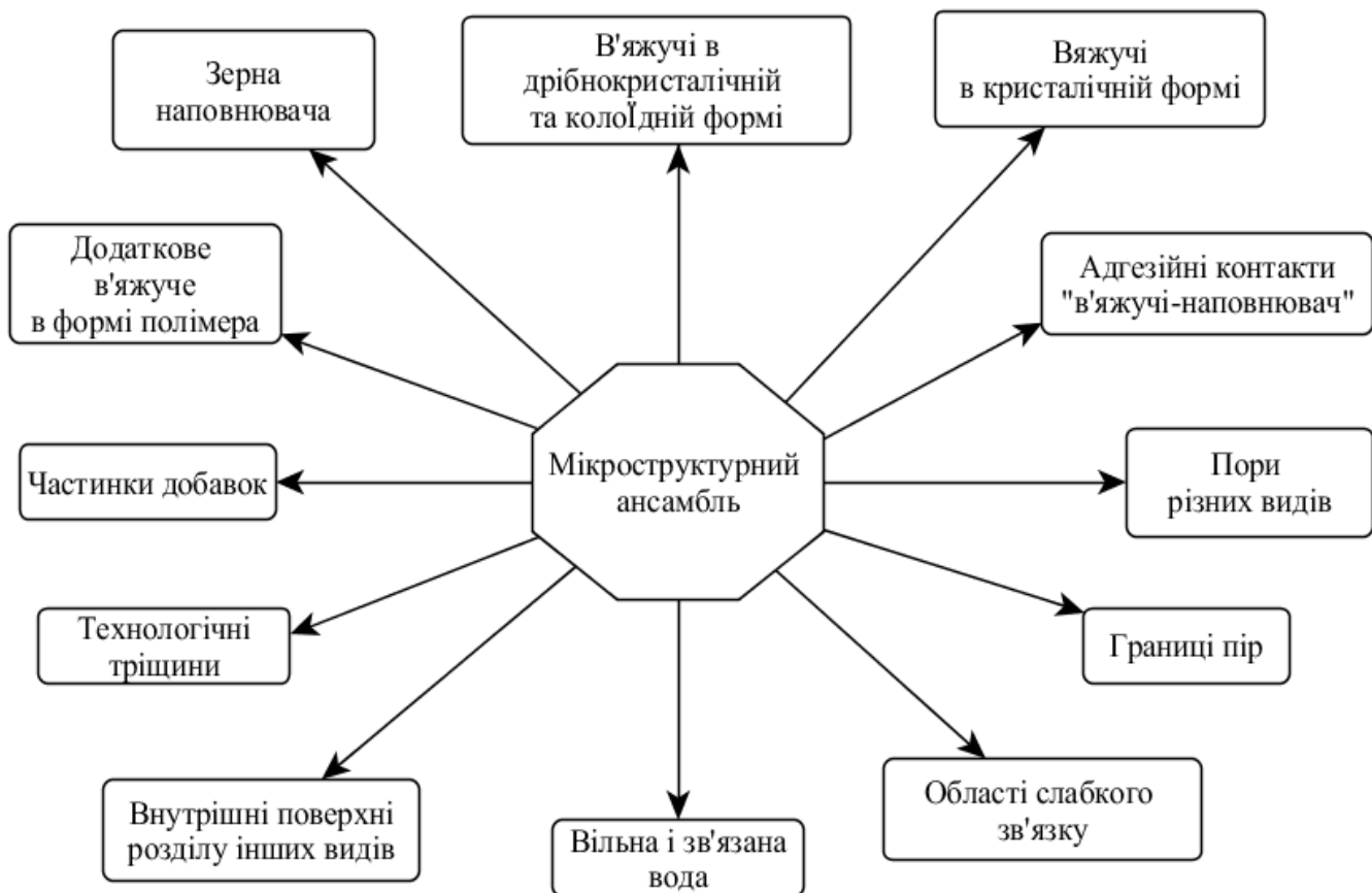
Рис. 5.10. Уявлення про поровий мікροструктурний ансамбль матеріалу
