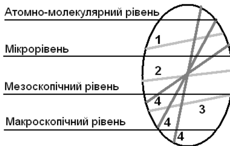
Рис. 2.2. Схематичне відображення системної класифікації методів досліджень матеріалів: 1 – атомно-силова мікроскопія; 2 – скануюча електронна мікроскопія; 3 – різні види оптичної мікроскопії; 4 – «крізьмасштабні» методи досліджень матеріалів
