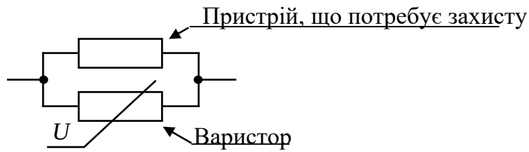
Рис.7.6. Схема включення варистора для захисту пристроїв від імпульсних перевантажень
