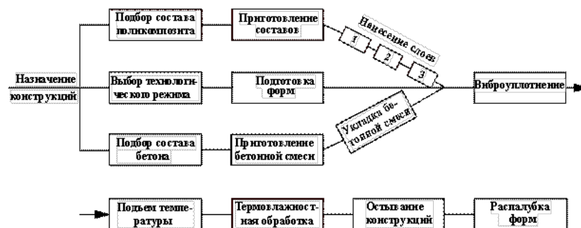
Рис.1. Общая параллельно-последовательная схема технологических процессов Вероятность безотказной работы параллельной части схемы определяется по формуле:
