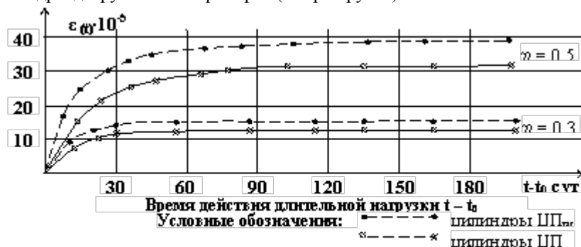
Рис. 1. Изменение относительных деформаций кремнебетона.
