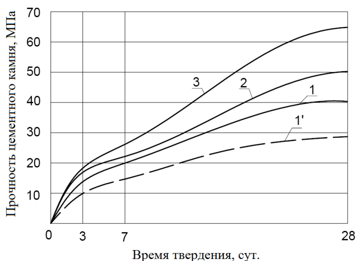
Рис. 7 Кинетика нарастания прочности цементного камня
