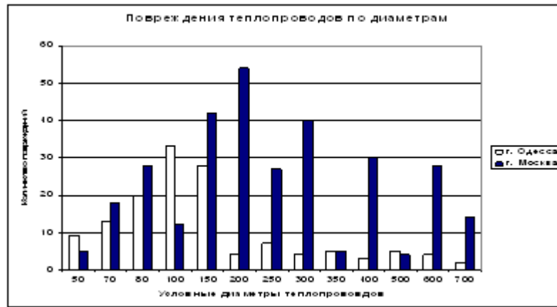
Рис. 1. Гистограмма повреждений теплопроводов для определения наиболее уязвимого диаметра теплопровода
