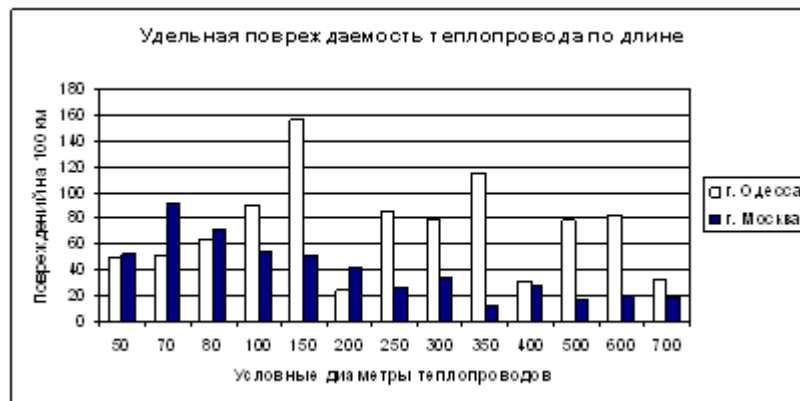
Рис. 2. Гистограмма показателя удельной повреждаемости Теплопроводов
