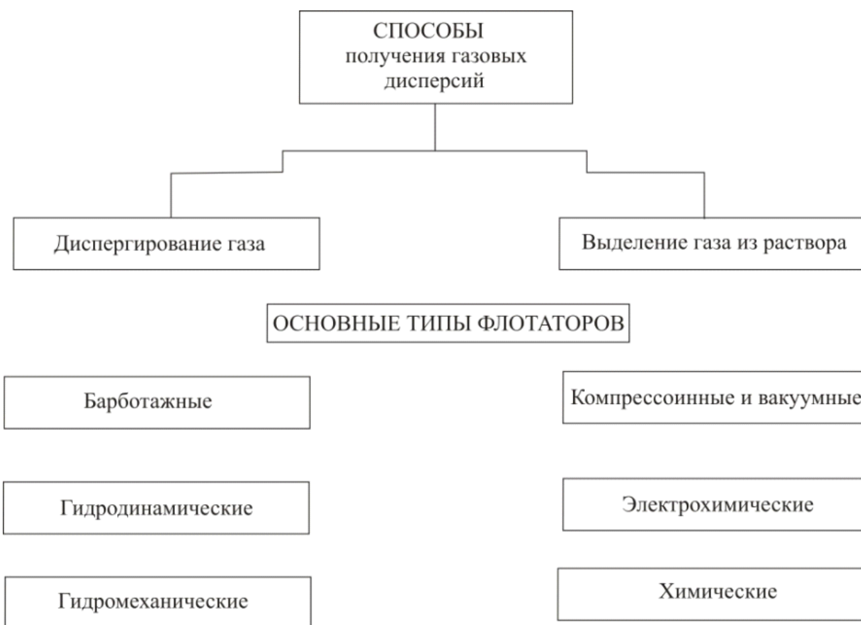
Рис. 1. Классификация флотационных установок и сооружений по способу получения ДГФ
