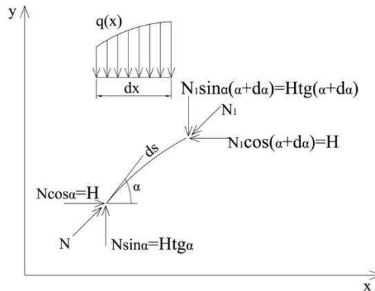
Рис. 1. Элемент арки.
