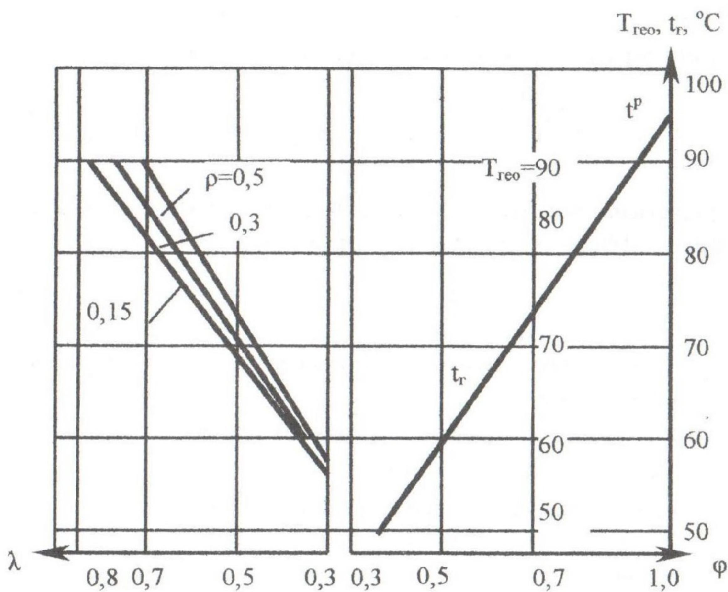
Рисунок 2. Зависимость  $\phi$  и  $\lambda$  от  $T_{\text{рео}}$  при  $t_o^P = 4^\circ\text{C}$
