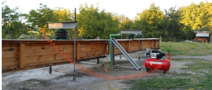
Рис. 3. Испытание натурной конструкции на действие статической нагрузки в трещах пролета
