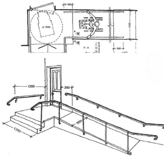
Рис.1 Пример устройства входной лестницы и пандуса
