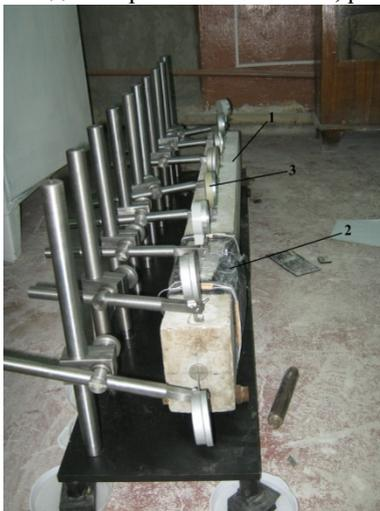
Рис. 1. Методика локального увлажнения бетонных изделий. 1 - бетонная балка размером 120x15x10 см; 2 - зона увлажнения; 3 - индикаторы часового типа с ценой деления 0,001 мм.
