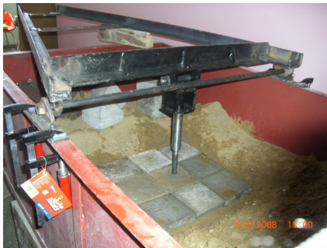
Рис. 1. Общий вид испытательного лотка в комплекте с рычагом до установки измерительных приборов
