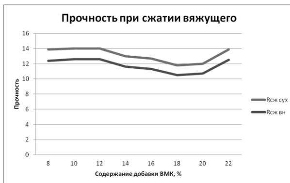
Рис. 2. Характеристика прочности вяжущего
