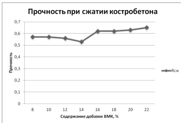
Рис. 4. Характеристика прочности костробетона
