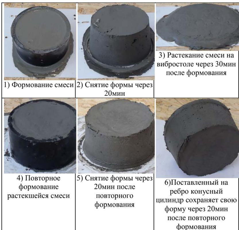
Рис. 2. Фотофиксация состава смеси №4 при вибровоздействии на сформованную смесь, и последующее ее повторное формование
