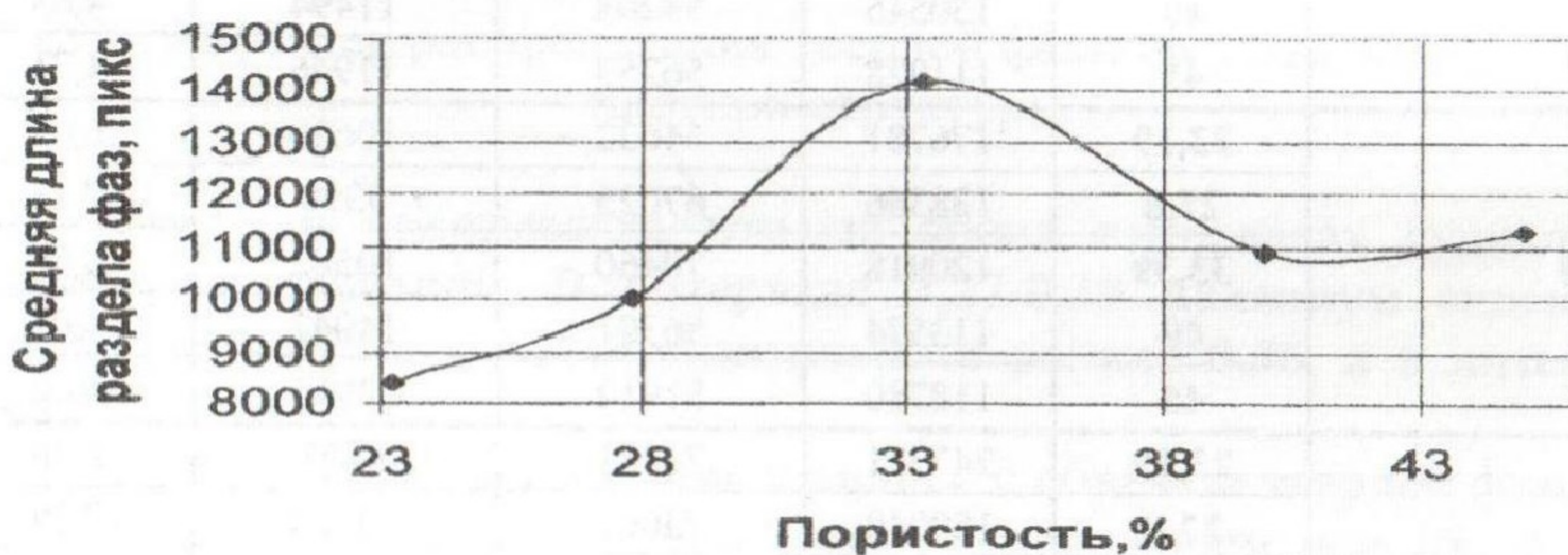
Рис. 8. Характер распределения твердой фазы на моделях материала пористой структуры.
