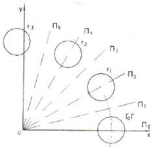
Рис.3 Модель расчета с регулярным кольцом круговых включений
