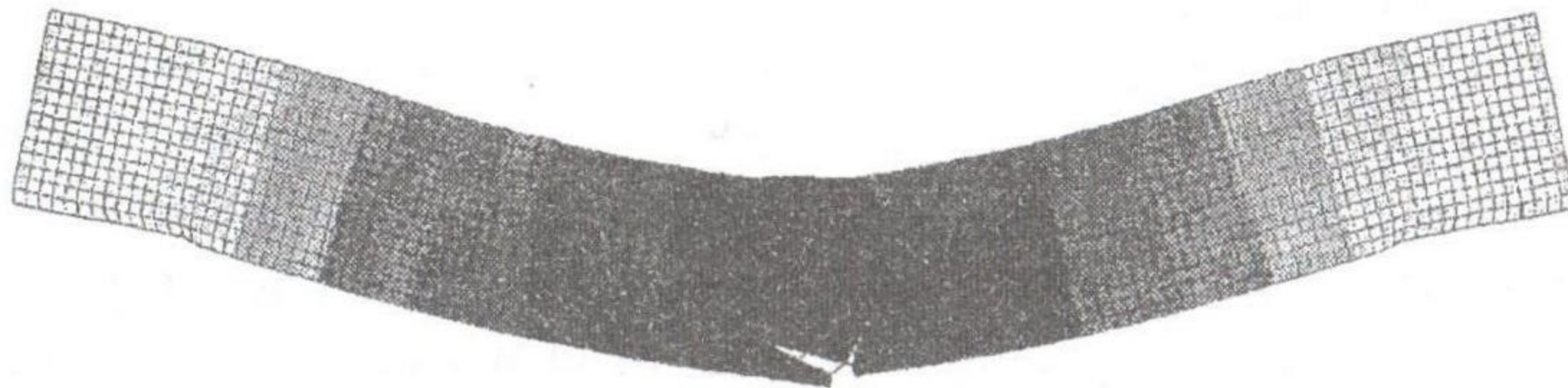
Рис. 4. Деформированная схема при разрушающей нагрузке.
