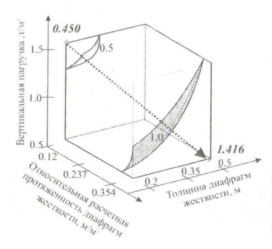
Рис. 2. Влияние относительной расчетной протяженности диафрагм жесткости, величины вертикальной нагрузки и толщины диафрагмы
