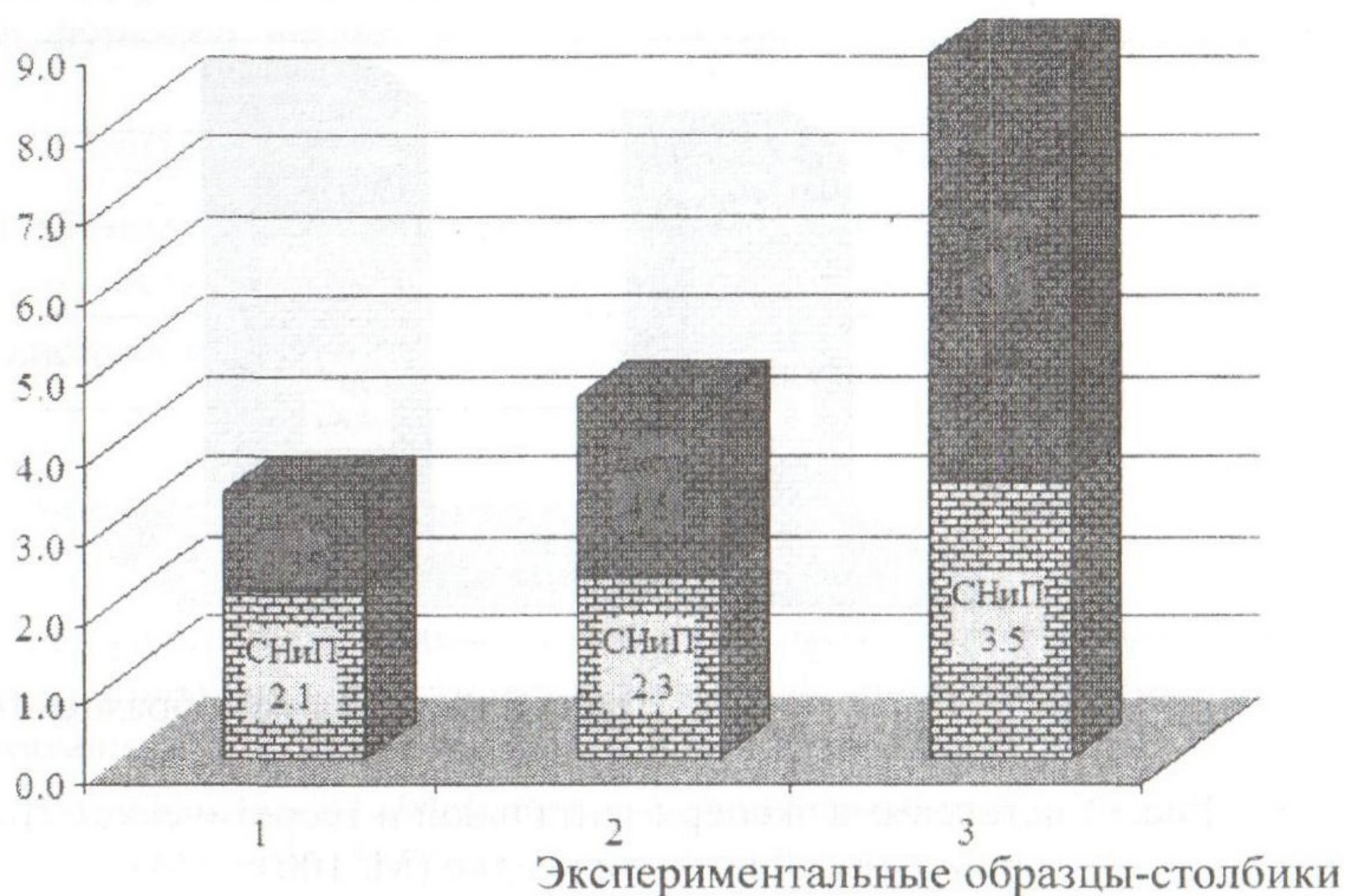
Рис.2 Гистограмма экспериментальной и теоретической границы прочности кирпичной кладки ( M_k50 , M_k75 , M_k125 ) по [3].
