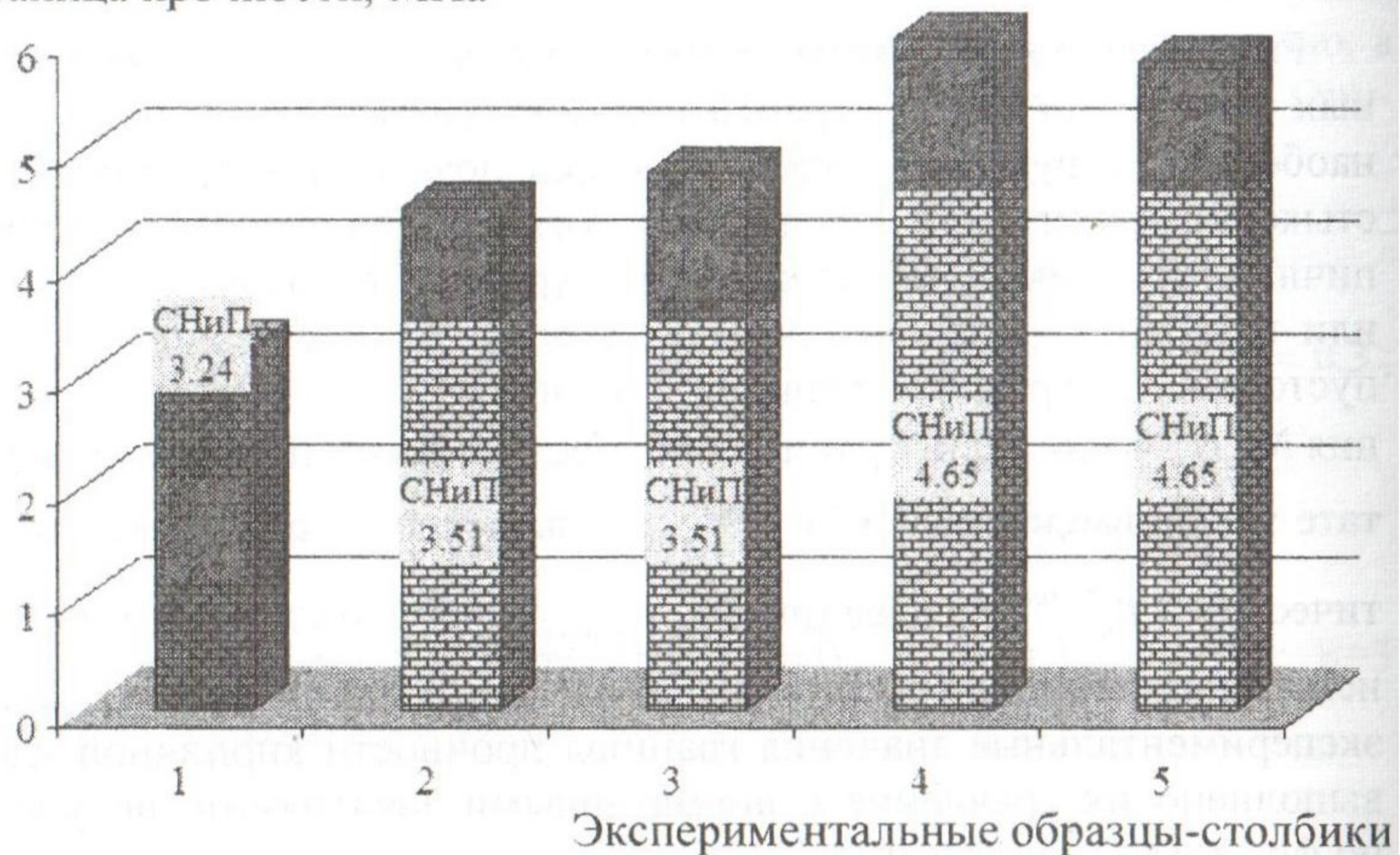
Рис. 1 Гистограмма экспериментальной и теоретической границы прочности кирпичной кладки.
