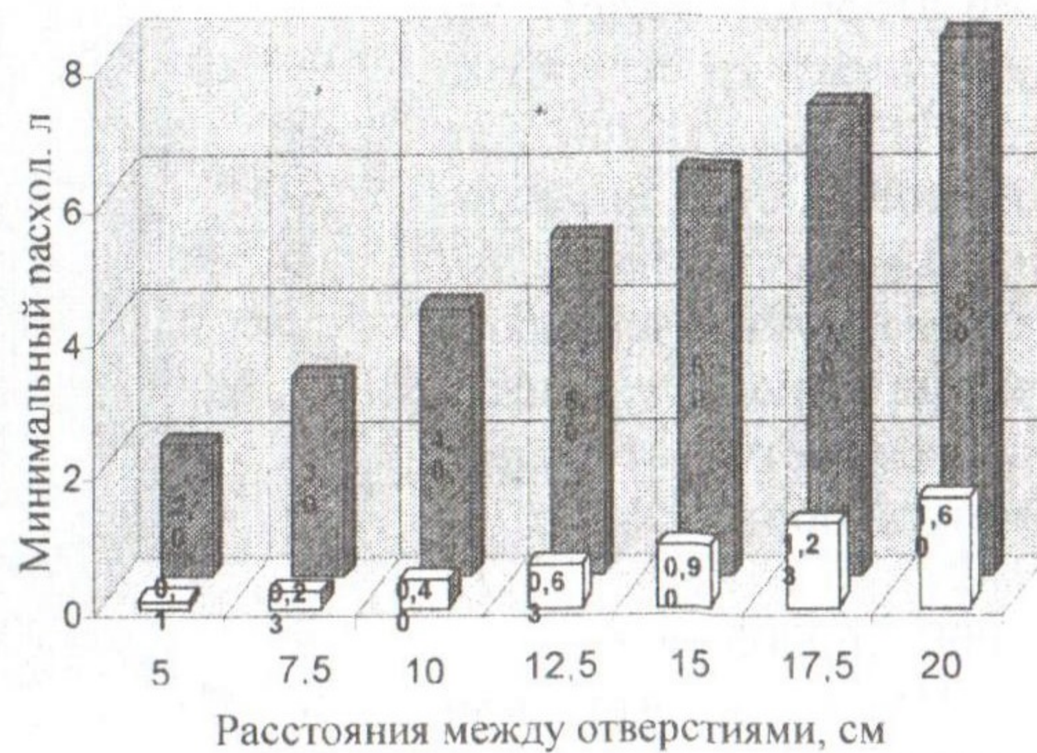
Рис.3. Зависимость расхода гидрофобной жидкости от расстояний между отверстиями.
