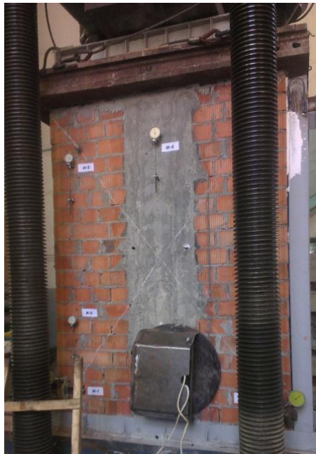
Рис.4. Экспериментальный образец с установленной вибромашиной
