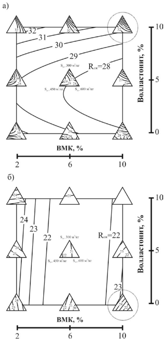
Рис. 1. Влияние добавок-модификаторов и наполнителя в виде песка (а) и трепела (б) с разной удельной поверхностью на прочность при сжатии активированной мелкозернистой бетонной смеси ( $C-3=1,5\%$ )
