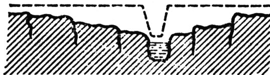
Рис. 8.1. Схема просадних явищ у лесових породах у результаті фільтрації води зі зрошувального каналу. Пунктиром показане первісне положення поверхні землі й каналу
