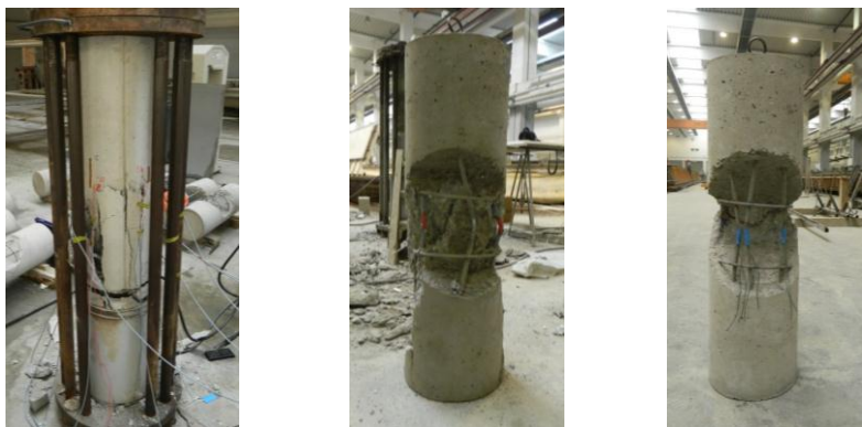
Рис. 10. Испытанные модели после разрушения элементов.
