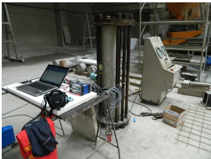
Рис. 3. Установленная колонна и проведение эксперимента.
