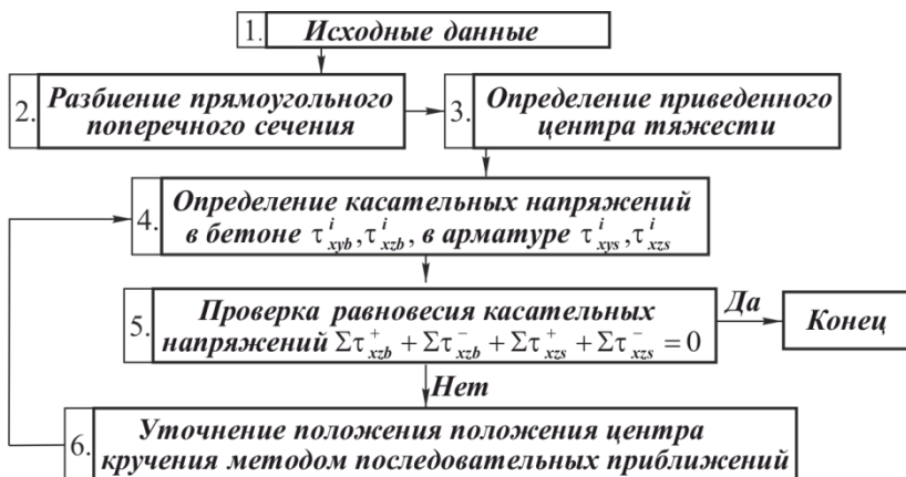
Рис.5 Блок-схема определение центра кручения
