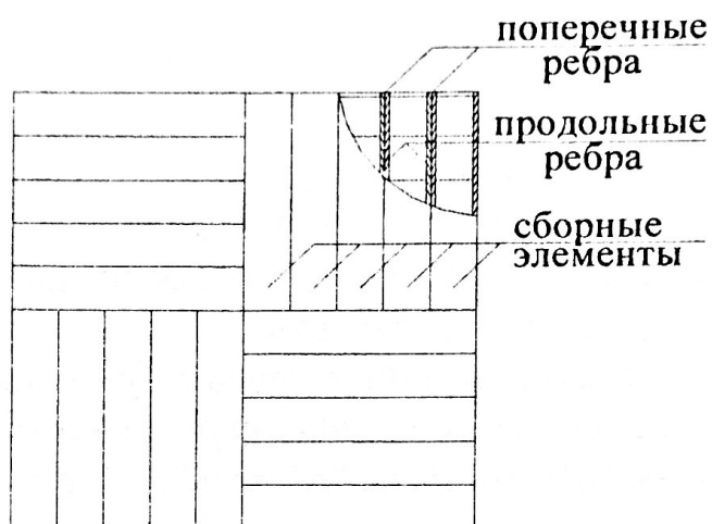
Рис. 1 Схема разбивки лепестка составной оболочки на сборные элементы.
