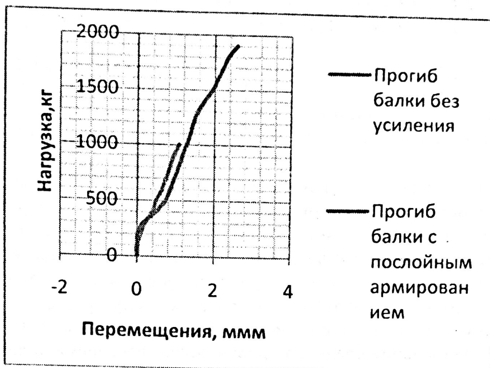
Рис 3 Кривые прогибов балки без усиления и балки с послойным армированием
