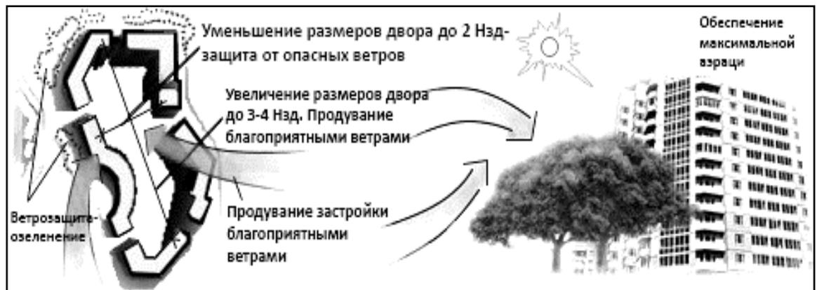
Рис. 2. Пример схемы застройки для **прохладно-комфортной погоды**
