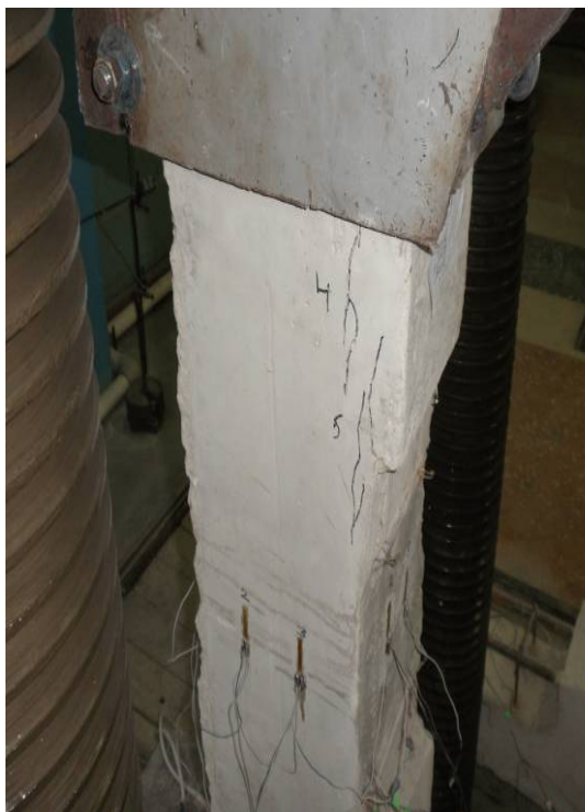
Рис. 3.13. Скол бетона над повреждением.
