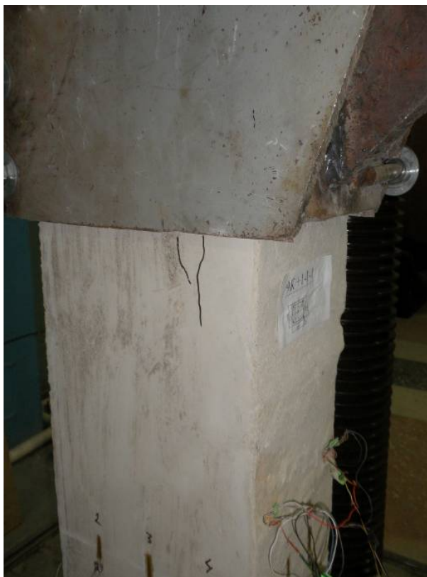
Рис.3.12. Образование трещин у основания оголовка: а – образец 1-1-1; б – образец 1 1-1.
