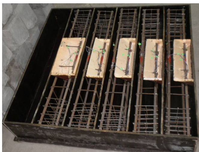
Рис.2.7. Монтаж моделей повреждений на проектные места.
