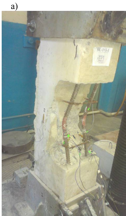
Рис. 3.14. Искривление стержней арматуры образцов: а – -1-1-1; б – -1 1-1.
