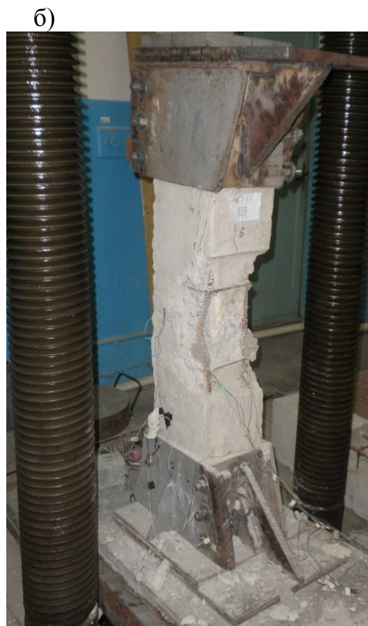
Рис. 3.14. Искривление стержней арматуры образцов: а – -1-1-1; б – -1 1-1.
