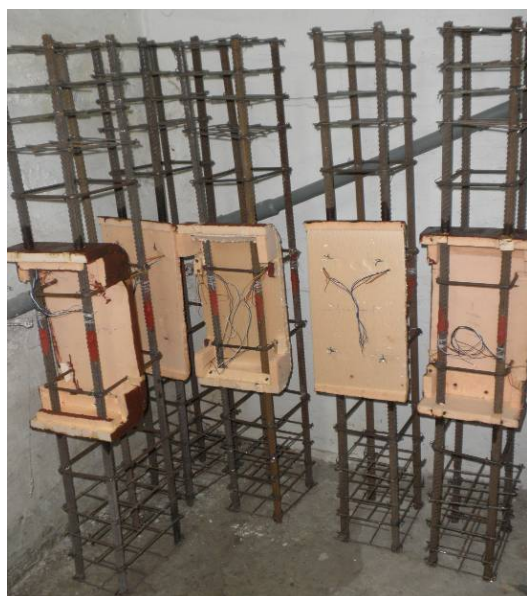
Рис.2.7. Монтаж моделей повреждений на проектные места.
