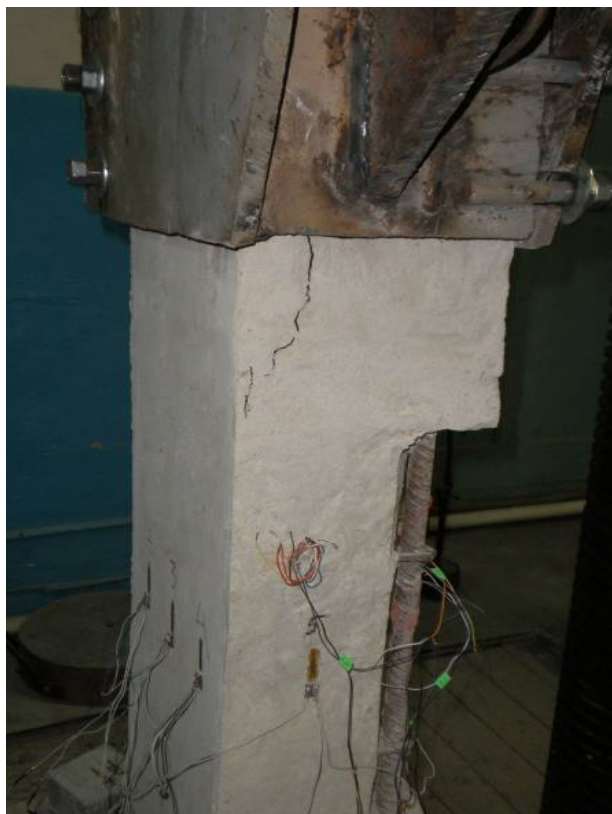
Рис.3.12. Образование трещин у основания оголовка: а – образец 1-1-1; б – образец 1 1-1.
