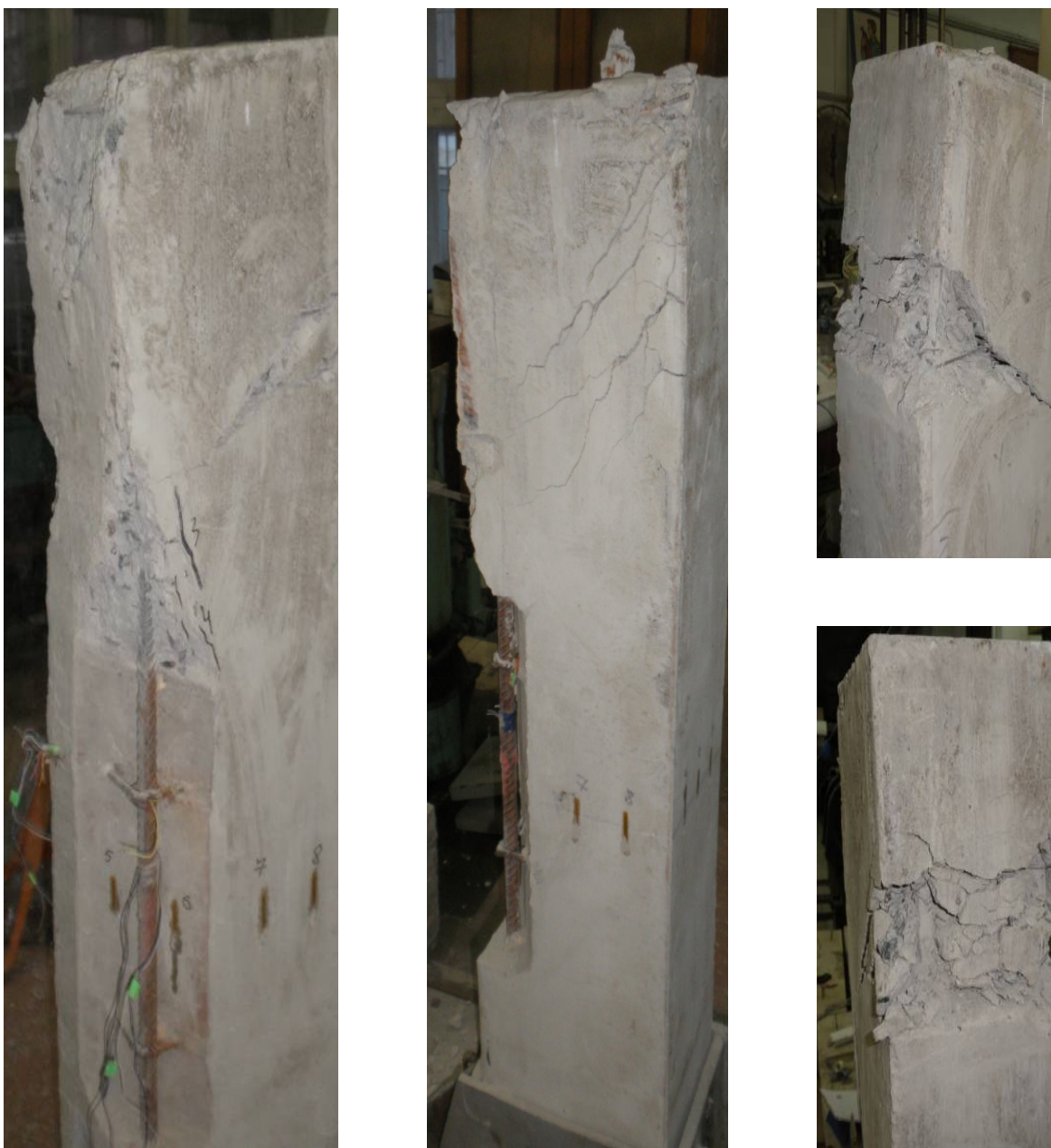
Рис.3.16. Типичный характер разрушения образцов с e_0/h = 1 .
