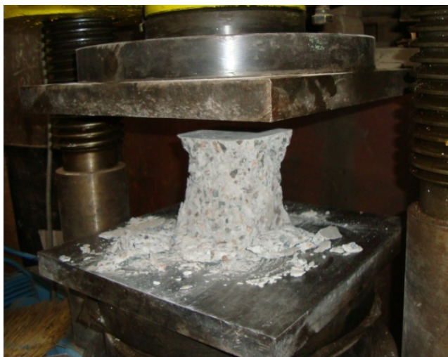
Рис. 3.8. Разрушение опытных кубиков.
