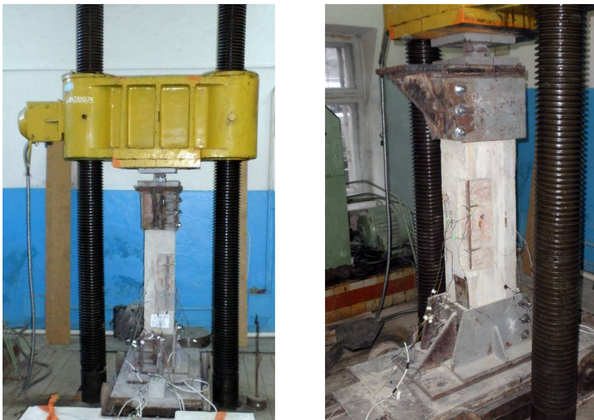
Рис. 2.11. Общий вид установки для испытания колонн.
