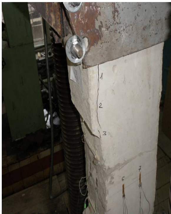
Рис.3.12. Образование трещин у основания оголовка: а – образец 1-1-1; б – образец 1 1-1.
