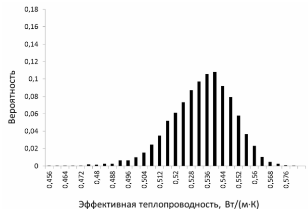
Рис. 1. Распределение \lambda_{eff} , полученное в материале с a = 4h , d_{min} = 0 и \eta = 0,28 / \lambda_{eff} distribution in the material with a = 4h , d_{min} = 0 and \eta = 0,28 .
