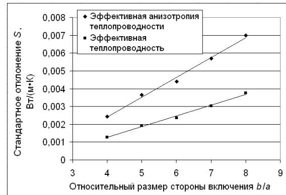
Рисунок 4 – Зависимость S_{at} и S_{tc} от размера включений
