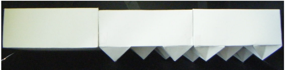
Рис. 4. Макеты фигурных элементов мощения с плоским основанием, с рифленным основанием с пятью зубчатыми элементами пирамидальной формы и с рифленным основанием с пятью четырехконечными звездчатыми элементами пирамидальной формы
