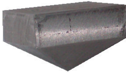
Рис.1. Модель фигурного элемента мощения с пирамидальным основанием
