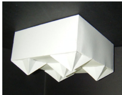
Рис. 3. Макет фигурного элемента мощения с рифленным основанием из пяти четырехконечных звездчатых элементов пирамидальной формы
