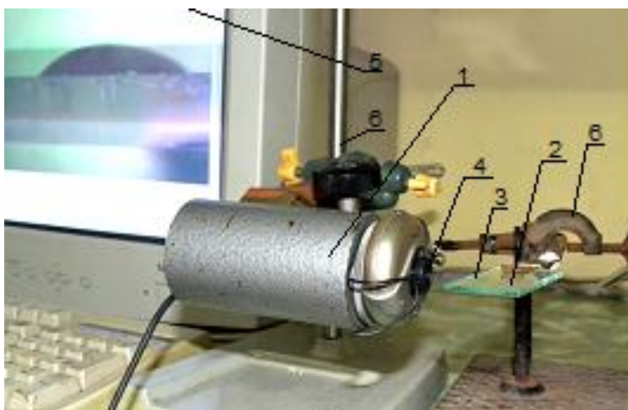
Рис.1. Схема установки для вимірювання краєвого кута:
