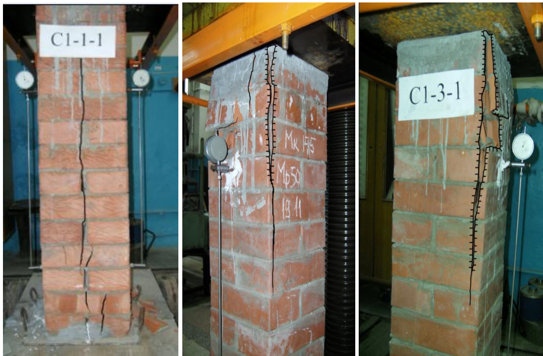
Рис.3.1. Характер руйнування зразків-стовпчиків
