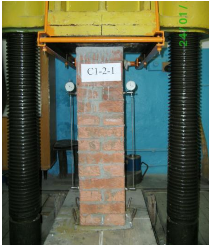
Рис. 2.8. Вигляд цегляного стовпчика у процесі випробування
