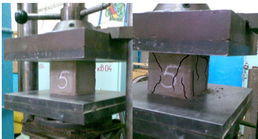
Рис.2.7. Вигляд зразка розчину до та після випробування
