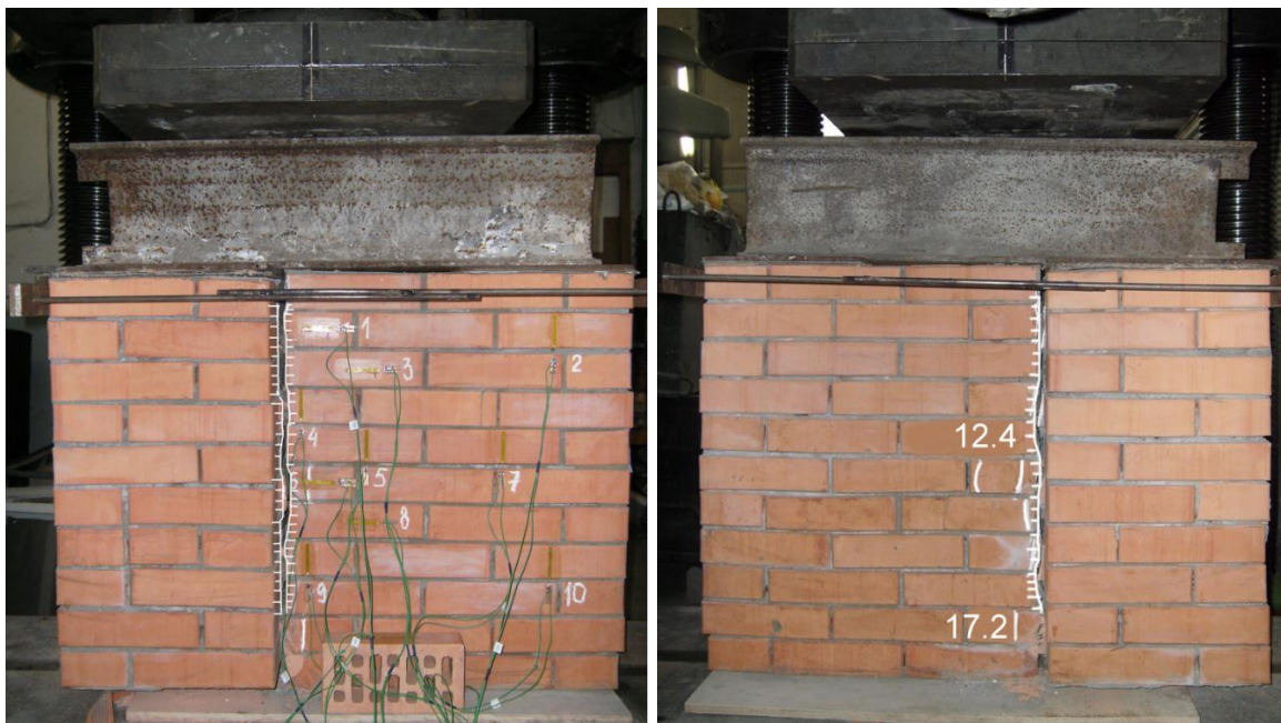
Рис.3.14. Зразок С3.1-3 після випробування
