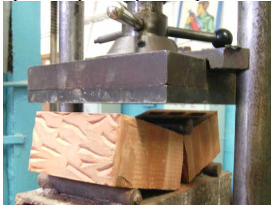
Рис.2.6. Руйнування цегли при випробуванні на згин
