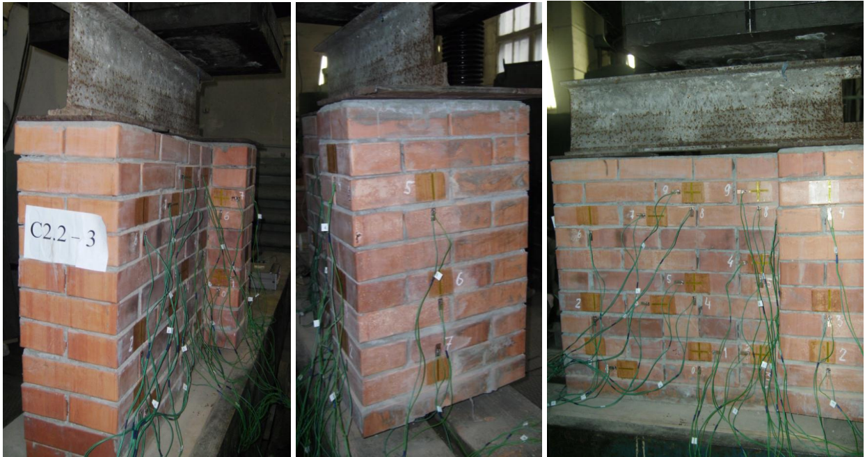
Рис. 2.10. Вигляд цегляного зразка-стінки С2.2-3 у процесі випробування
