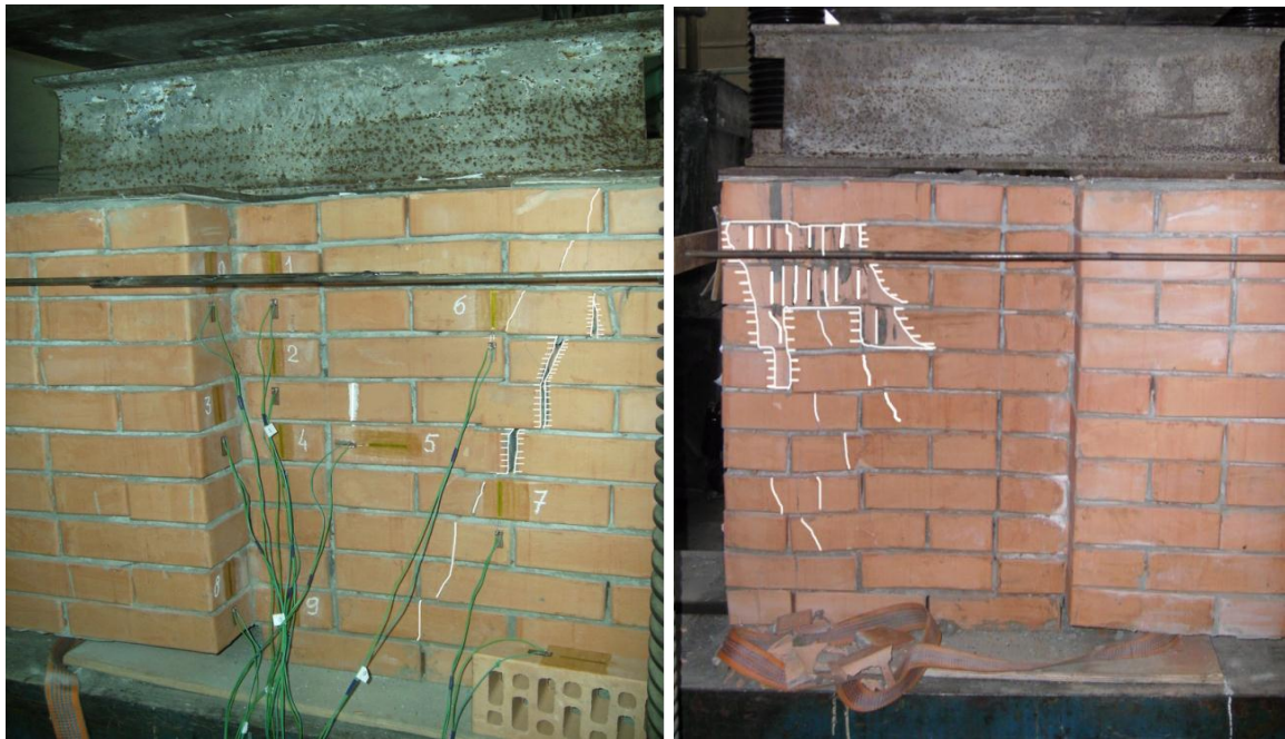
Рис.3.15. Зразок С3.3–3 після випробування
