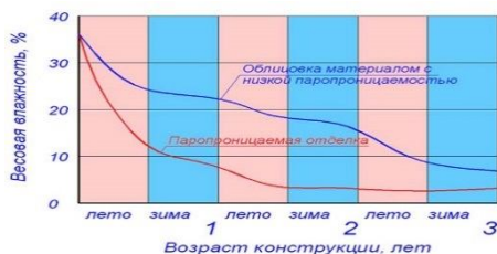
Рис. 3. Скорость высыхания стеновой конструкции в зависимости от паропроницаемости наружного штукатурного покрытия
