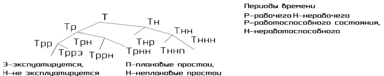
Рис. 3 – Граф возможных состояний машины в процессе ее эксплуатации
