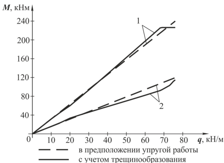
Рис. 3 Зависимость значений изгибающих моментов в ригелях крайних пролетов первого этажа от величины нагрузки: 1 – в опорном сечении; 2 – в пролетном сечении.
