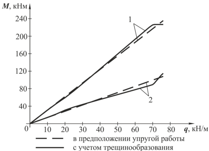
Рис. 4 Зависимость значений изгибающих моментов в ригелях крайних пролетов первого этажа от величины нагрузки 1 – в опорном сечении; 2 – в пролетном сечении.
