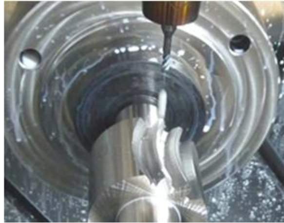
Рис. 4. Чорнове фрезерування аркових зубців
