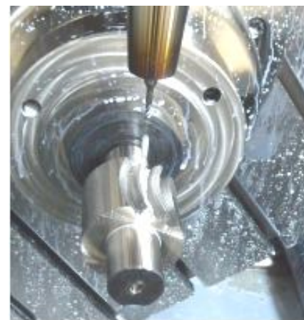
Рисунок 7 - Черновое фрезерование арочных зубьев
