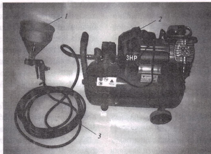
Рис. 4. Комплект технологічного обладнання, яке використовується для виготовлення тонкостінного покриття й замоноличування стиків тонкостінних елементів:
